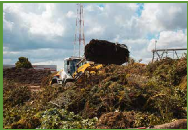
Les déchets verts ne correspondant pas aux normes de criblage seront réintégrés par la suite dans le processus de compostage.
